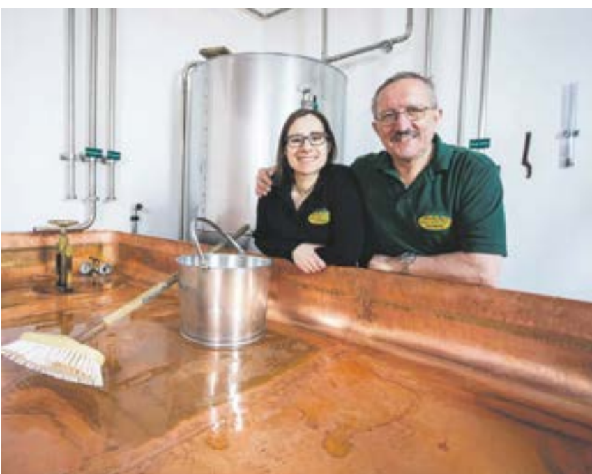
Das Prunkstück des Sudhauses ist das Kühlschiff, eine Art Wanne aus Kupfer, in der die gekochte Würze heruntergekühlt und geklärt wird.
